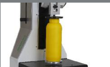
Drucktest an Flaschen (Topload)
