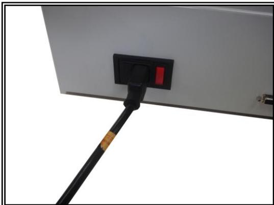
Connectez le câble secteur à l'embase secteur situé sur la face arrière de votre couplemètre, et effectuez une charge des batteries pendant 4-6 heures. Utilisez uniquement l'adaptateur fourni par ANDILOG
