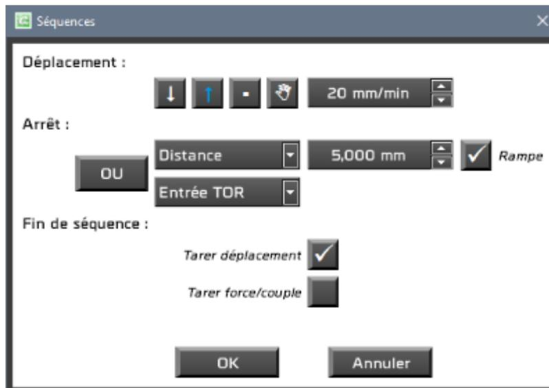
**DEPLACEMENT** Vers le haut (sens croissant) ou vers le bas (sens décroissant). Le carré permet de faire une séquence sans déplacement. Dans ce cas, la vitesse sera nulle et la condition d'arrêt se fera obligatoirement sur le temps.
