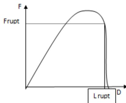
**% ELONGATION RUPTURE** Détermine le pourcentage d'allongement de l'échantillon par rapport à sa longueur d'origine. Ce calcul n'est disponible que lorsque « Rupture » a déjà été choisie.
