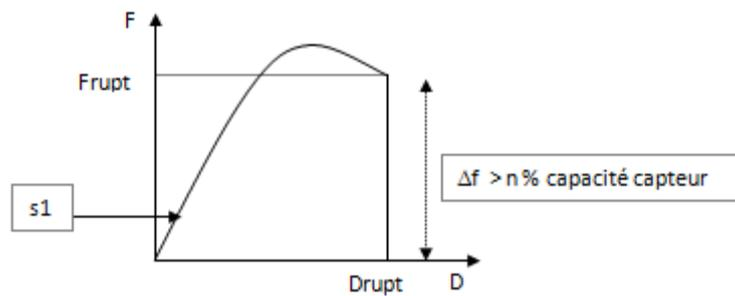
**ELONGATION RUPTURE** Calcule la longueur Lrupt d'élongation de l'échantillon entre 1% de la capacité du capteur et la rupture. Ce calcul n'est disponible que lorsque « Rupture » a déjà été choisie.
