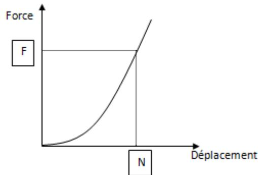
**POSITION RUPTURE** Mesure le déplacement au moment de la rupture. Ce calcul n'est disponible que lorsque « Rupture » a déjà été choisie.
