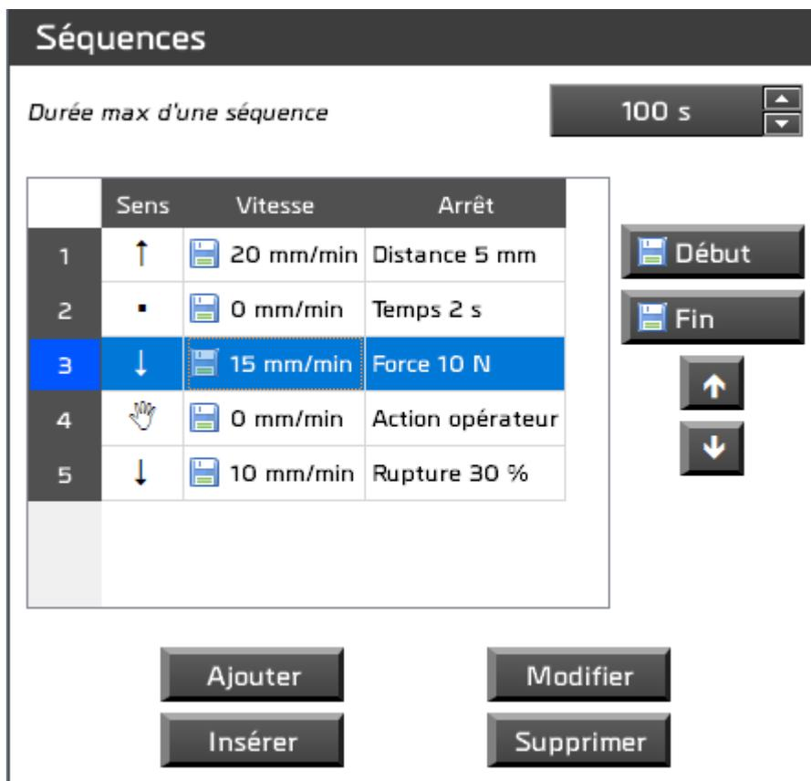
La durée maximale d'une séquence permet de définir une sécurité dans le cas où une séquence ne s'arrête pas comme défini.
