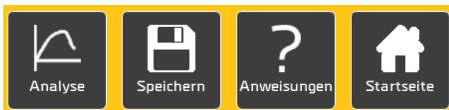
**ANALYSE** Ein Klick auf diese Schalttaste führt zur Analyseseite. Vorab wird die Konfiguration gespeichert.
